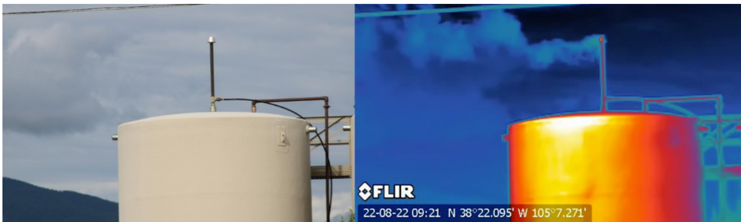
Tanque de petróleo bruto em Florence, CO (esquerda) e pluma de hidrocarbonetos capturada por meio de uma câmera FLIR GF320 (direita).
